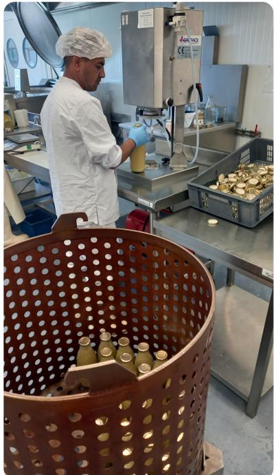
L'équipe procède ensuite au **dosage**, au **remplissage** et à la **fermeture** des bocaux grâce à la **capsuleuse** : cette étape est très importante car elle garantit l'étanchéité et assure la qualité du produit avant le passage en autoclave.
